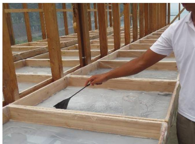
また、濃縮された海水からは塩分（塩化ナトリウム）よりも先に、他の塩（えん）・・・が沈殿します。雑塩が多いと味が落ちるので、網ですくって除去します。
