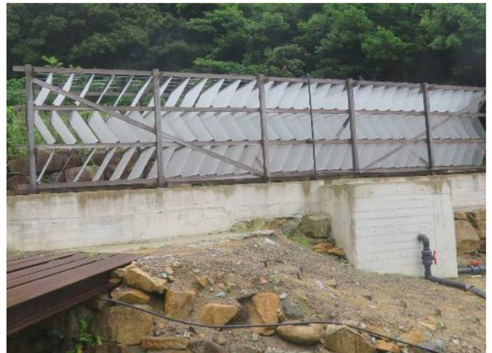
この製塩所の最大の特徴は「流下式製塩法」を用いていることです。製塩方法には、塩田に海水を引き込んで天日で乾燥させる「天日製塩法」、濃縮した海水を塩釜で煮詰める「煎熬採塩法」、「イオン交換膜製塩法」などがあります。沖の島の製塩所で採用している「流下式製塩法」は、本来は「枝状架」と呼ばれる枝状の器具に海水や塩分を含んだ温泉水を流下させ、余分なミネラルを吸着させ、水分も蒸発させる方法です。
