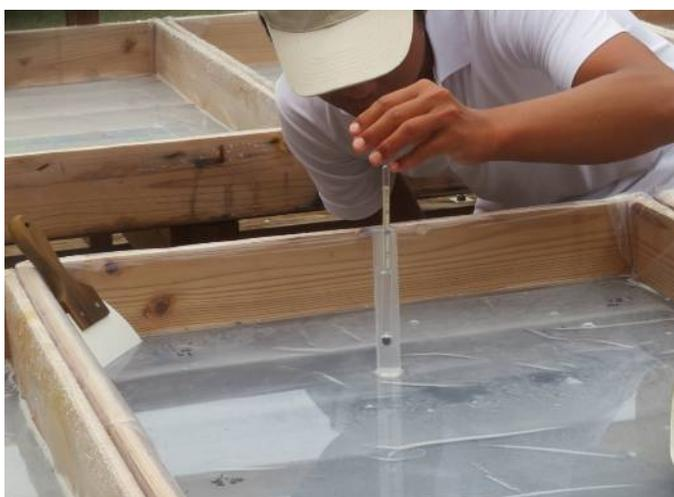
製塩も全自動ではなく、時々比重計を使って、濃縮された海水の濃度を計測しています。
