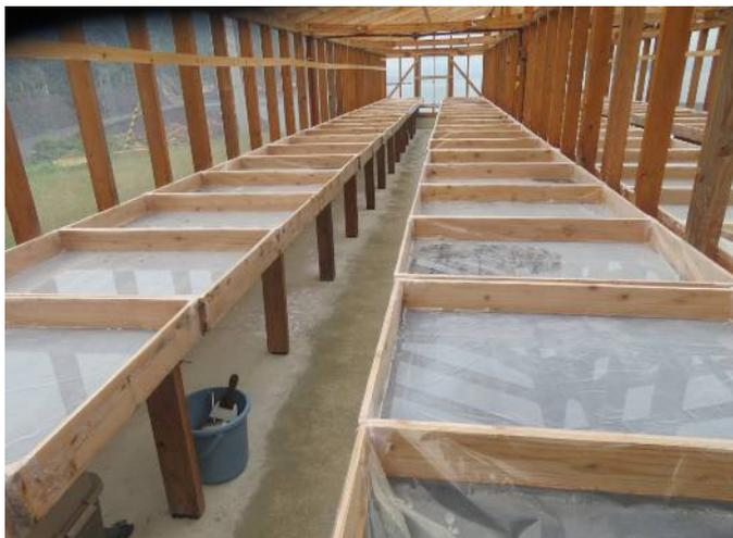
流下架だけでは塩はできません。濃縮された海水は、ビニールハウス内の「塩田」に移されて、更に水分を蒸発させます。火力を使わずに、自然の風や天日だけで製塩している点が素晴らしいです。
