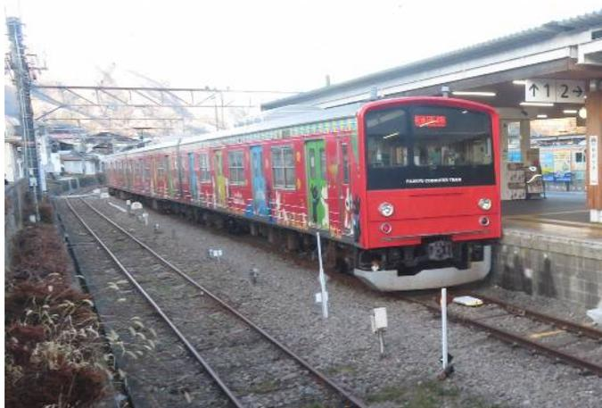
駅前から、富士急行の各駅停車の電車が見えました。地方私鉄のご多分にもれず、富士急行でも他の鉄道会社から譲渡された車両を使っています。写真は元JRの「205系」という通勤型電車を改造したものです。少し前までは、京王線の旧5000系電車も走っていました。私が通学で使っていたなつかしい電車でした。
