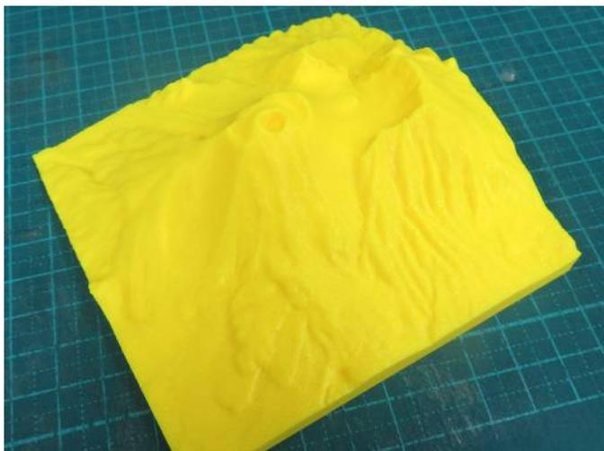
これができ上がった「浅間山の立体模型」です。浅間山の特徴である、「二重の外輪山」が見事に表現されています。単色造形なので写真ではわかりにくいと思いますが、右側の外輪山の浸食谷や、山頂火口壁(釜山)の形状、それに側火山(小浅間山、石尊山)もよく表現されています。
