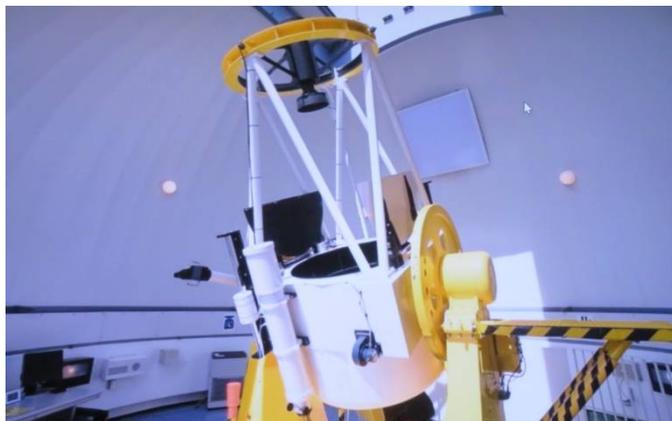
この大型の「反射望遠鏡」は九州地方最大の口径だそうです。驚いたのは「赤道儀」ではなく「経緯台」
