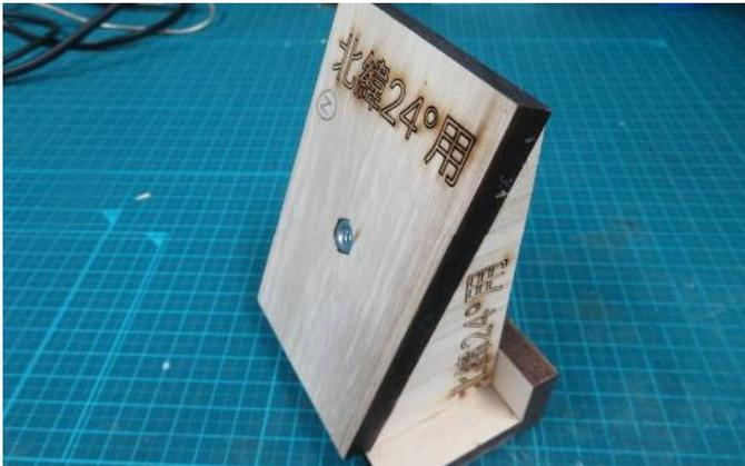
最初の試作品がこの写真です。ナノトラッカーを水平に対して24度上方(天頂)に向けて傾けて設置する台座です。特に「24度という角度」を正確に切り出しました。中心と裏面には、ナノトラッカー・三脚取付用の3/4ナット(三脚ねじ用)もつけてあります。
