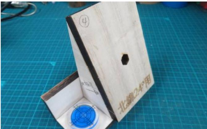
赤道儀の設置で重要なのは、設置面の水平です。そこで第二試作品には、簡易水準器も取り付けました。これで恒星の追尾精度は格段に向上します。
