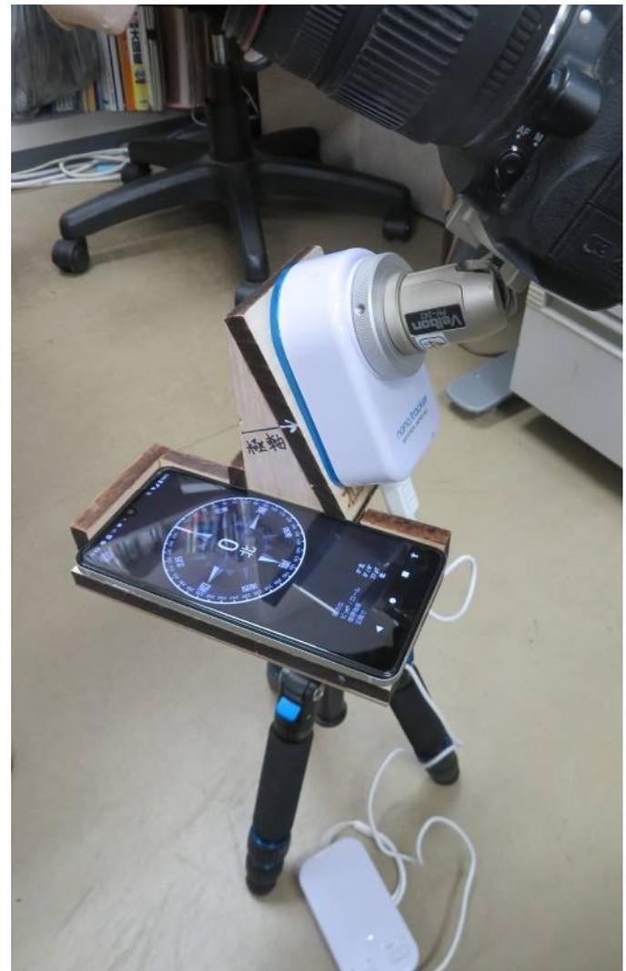
この台座を使って、ナノトラッカー、自由雲台、カメラ、スマホを三脚に設置した様子です。スマホには「方位と水平」を表示するアプリを入れてあります。これで、ナノトラッカー台座を水平に設置できると同時に、正確な極軸(北方位)をとることができます。
