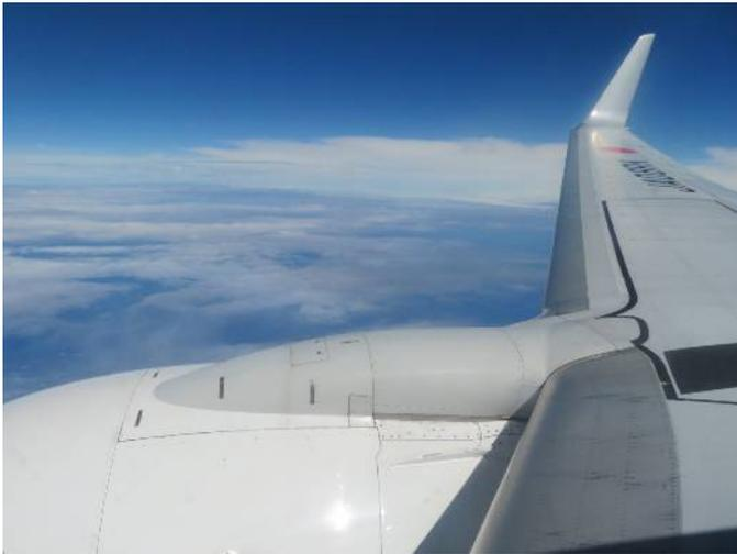
私の座席は翼の上で、景色はあまりよく見えませんでした。しかし、飛行中の「翼の変化」が面白いと思いました。空港での駐機中は、翼の先端は下に下りています。しかし航行中は翼の先端が相当にせり上がるのです。航空機の翼というのは、強靱かつしなやかに設計されていることがわかります。
