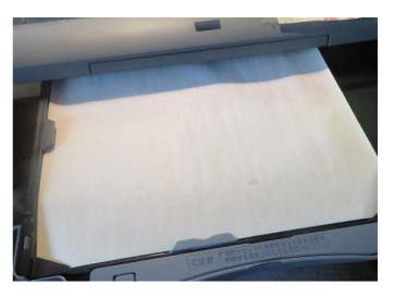
カラー印刷には専用のインクリボンが必要だが、モ ノクロ印刷は感熱紙にもできる。本体下部のトレイに は、当時入れた感熱紙もそのまま入っていた。
