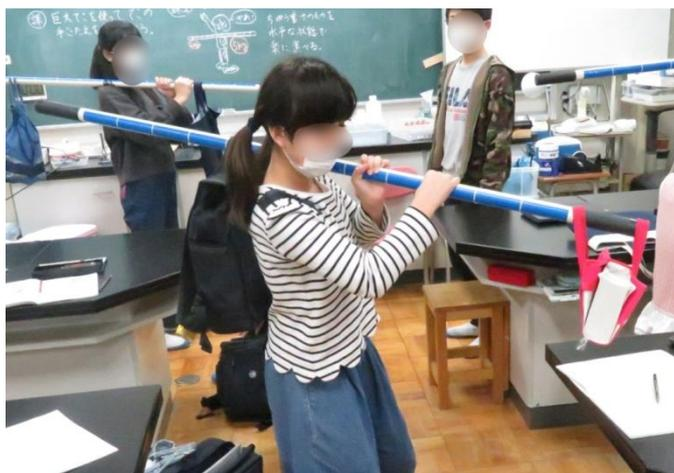
実験では、棒の重さを無視する為に、棒の中心(支点の位置)を担ぐというルールにした。こうすると、写真のように非常に軽いもの(水筒)を棒の端に、重いものを(かばん)を支点に近いところに提げれば、棒は水平に近くなる。棒が水平になると、支える手は余計な力を加えなくて済む。
