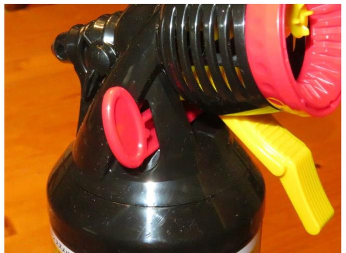
噴射レバーも、普通の殺虫剤のものよりもずっと大きい。しかも、消火器のように「安全ピン」がついている。噴射力が強いので「誤爆」を防止するためのものだ。巣を退治する場合は、「小分け噴射」ではなく、一気に噴射する必要がある。一気に噴射すると、30秒ほどで全量がなくなるらしいので、相当な威力だ。
