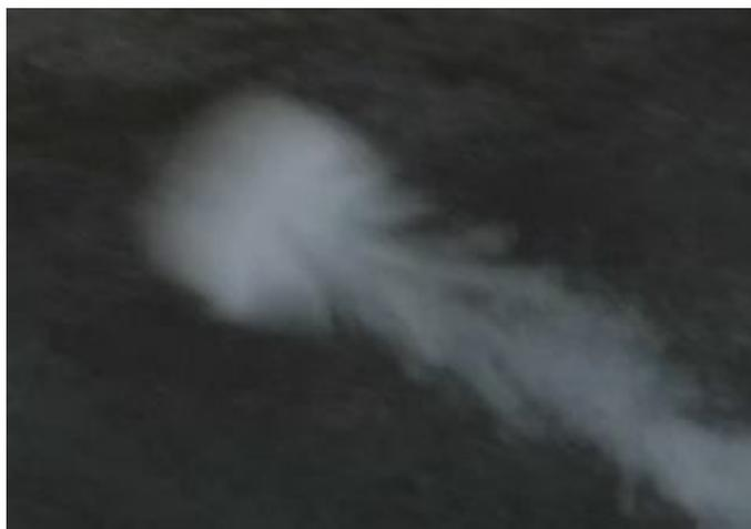
肉眼では一瞬なのでよくわからないが、あとから写真でよく見ると、先端部は原爆の「キノコ雲」にそっくりである。中心部の風圧が一番強いので、それに押されるように先端部の煙に入り込んでいくようだ。最終的に穴があき、リングが形成されるのだろう。
