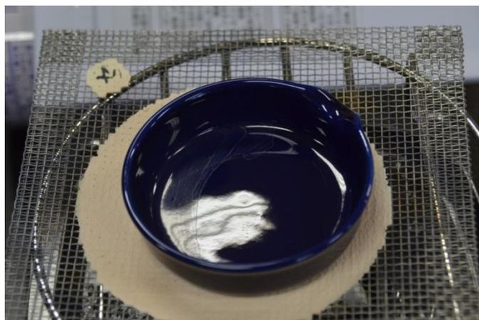
弱火でも数分で水は蒸発する。すると、蒸発皿の底に白いものが必ず残る。実験前に水、アルコール、ペーパーなどで、念入りに洗浄していたにもかかわらず、水道水から残渣物が出てきたので、子どもたちは大いに驚いていた。
