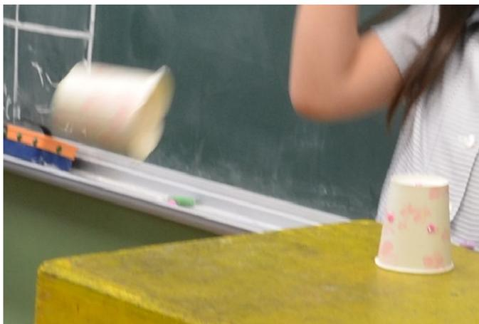
紙コップを2個使った「紙コップロケット」は、輪ゴムの性質を利用したものの中でも、一番簡単に作れる。確か教科書にも載っているものだ。上に載せるコップには、口の部分に十字型に輪ゴムが仕込んである。下のコップは何も仕掛けがなく、単なる発射台である。上のコップを発射台に強く押しつけて、手を離すと、一気に飛び出す。輪ゴムの数を増やすと、教室の天井付近まで跳ぶこともある。
