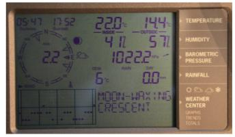
左上が日の出、日の入の時刻(現在時刻の表示も可)、 その下が現在の風向、風速、右列上から気温・湿度(屋外・室内)、気圧、雨量の表示だ。露点温度も表示される。一番下には各項目のグラフ表示や、天気予報、 2分間・10分間の平均風速なども表示可能だ。
