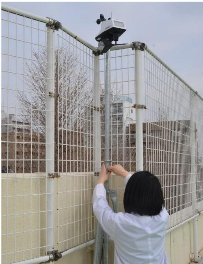
先日、少し前に理科室で購入した「ウェザーステーション」の設置をした。センサーは、頑丈な三脚の頂上に取り付ける。本来は三脚を平らな路面にビス止めするのだが、それは難しそうなので、屋上のフェンスの柱に固定した。理科室の教務補佐の大学院生さんがすべて組み立ててくれて、屋上への設置まで手伝ってくれたので、短時間で終わった。
