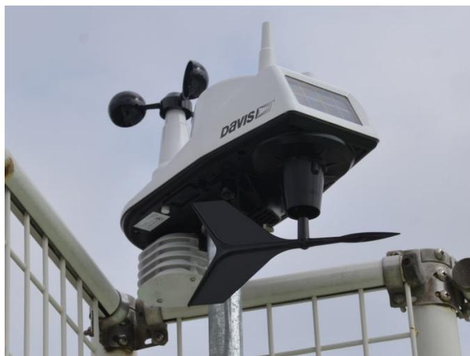
観測用のセンサーは、すべて一体型で、気温、湿度、気圧、風向、風速、それに雨量も測定できる。太陽電池と蓄電池内蔵で、無線でコンソール(表示器)にリアルタイムでデータを送信する優れたものである。
