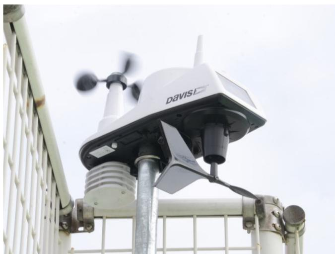
風速計は弱い風でもよく回る。風向計の動作も良好だ。次は表示器(受信側)の設定である。
