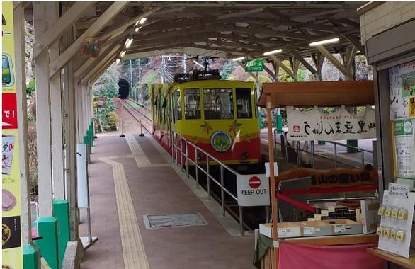
高尾山のケーブルカーは、鉄道としては日本で最も急勾配の路線だ。鉄道車両にもかわらず、運転士は乗務していない。乗務員は必ず乗っているが、それは乗客の安全確保、非常時対応の為の「車掌さん」である。ケーブルカーの動力は、車両自体には装備されていない。パンタグラフ(集電装置)と架線はあるが、それは室内灯や無線機の電源の為のものである。ケーブルカーを動かしているのは山頂駅の巨大な動輪なので「運転士」は山頂駅の動力室に常駐しているのだ。
