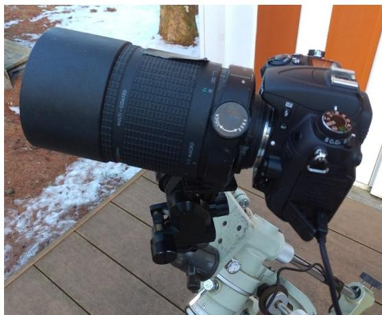
今回撮影に使った「フレックス(反射鏡型)超望遠レンズ」は、小型ながらも惑星の形もとらえる性能を有する。通常、三脚にはカメラ本体を固定するが、このような望遠レンズの場合、レンズのほうを架台に設置する。一番の「敵」は振動である。シャッターを切る時のミラーアップの振動さえ、撮影の障害になる。このカメラには、あらかじめミラーアップして、その後振動が収まってから露光する機能もあるが、「セルフタイマー」の使用も振動を抑えるのに効果がある。
