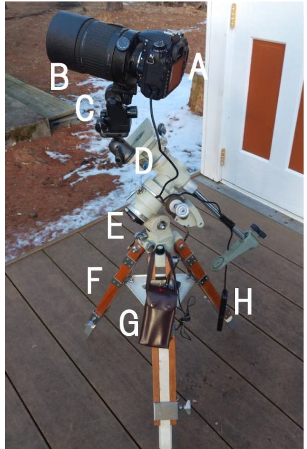
A ; デジタル一眼レフカメラカメラ本体 B ; フレックス望遠レンズ C ; 自由雲台と微動雲台 D ; 赤道儀 E ; 極軸望遠鏡 F ; 三脚 G ; 赤道儀の駆動電源 H ; 多機能レリーズ
