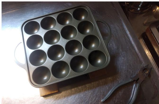
もう一つ用意したのが、この「たこ焼き器」である。これは鋳物 (鉄) 製で、少なくとも 1,000°C 以上に熱さない限り自身が融解することはない。これに液体の錫を流し込むと、タコ焼き器の鉄で冷却され、直後に固まって、固体の錫に戻るはずだ。当然「たこ焼きサイズ」の「錫チップ」ができるはずである。
