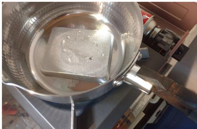
そこで、写真のように木製の柄はあらかじめはずしておく。大抵は柄の先端部のネジを+ドライバーで回すと、簡単に分離できる。分離したあとは、柄を固定していた金属部を、ペンチで挟むと良い。錫を融かす前に、頑丈なペンチでつかんでみて、持ち上げられるかどうか、しっかりリハーサルをしておく。
