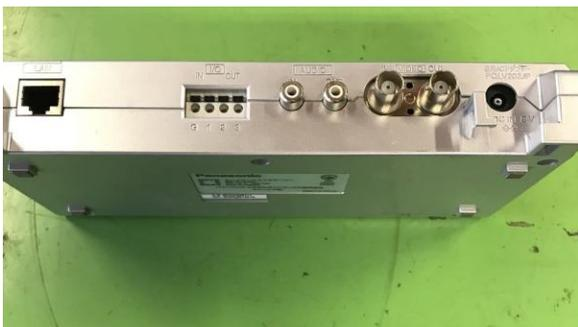
「外部出力端子」(写真の 4 つの穴) がついていて、100V 電源の ON・OFF を切り替えるリレーを遠隔操
