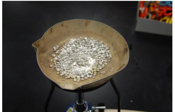
この「型」には、錫を流し込んで「铸造」することができる。錫は金属元素の一つで、融点が約 230℃と単体金属の中ではずば抜けて低い。アルマイト鍋とガスバーナーといった簡易な器具でも融解可能である。
