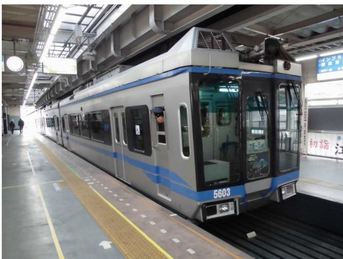
この切符では「湘南モノレール」にも全線乗車可能だ。湘南モノレールは、大船(JR大船駅)～江の島(湘南江の島駅)間を最短時間で結んでいる。終着駅から当の「江の島」まで、かなり歩くのが難点である。モノレールといえば、「東京モノレール」(浜松町～羽田空港)のように、1本のレールの上を走るタイプが多い。しかし湘南モノレールは、レールが車両よりも上にある「懸垂式」という珍しいタイプだ。最近まで上野動物園にあったものと同じタイプだ。従って、カーブでは車体が結構斜めに揺れる。住宅地の「上空」を結構な速度で走るの、初めて乗る人は少し怖いと思うかも知れない。
