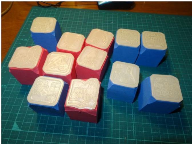
全部の印面を貼り終わった。1枚の紫外線硬化樹脂(はがきサイズ)から12個を一気に作れた。私は「かなり」慣れているので、原稿作成から12個のスタンプ完成まで、約40分だった。1個や2個なら15分程度で完成するので、依頼してきた同僚がいつも驚くことになる。
