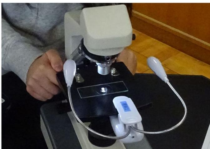
使い方は簡単で、顕微鏡のステージに挟んで、アームを自由に曲げて使う。これで「透過光」も「反射光」も自由に選んで結晶の観察ができるようになった。実際に観察するとわかるが、反射光のほうが実際の色に近く、圧倒的に美しく立体的に見える。
