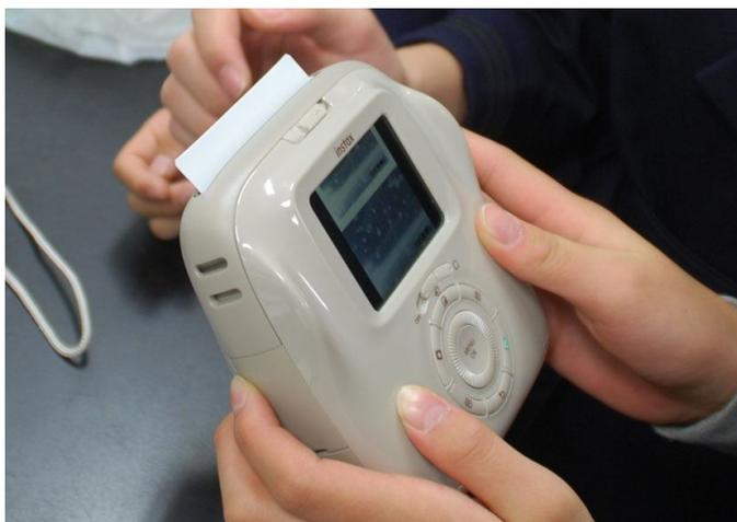
プリントしたい写真が決まったら、緑のボタンを押し、真ん中のOKボタンを押すと、プリントが始まる。画面の一部分を拡大したり、4枚の画像を「田型」に印刷することも可能だ。動画から切り出しての印刷もできるので、体育の授業でも役立ちそうだ。液晶画面が上にずれて、そのままプリントが出てくるような、楽しいデザインになっている。
