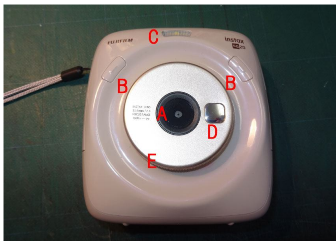
A ; レンズ (フォーカスフリー) B ; シャッター C ; フラッシュ D ; 自撮り用ミラー E ; ズーム環
