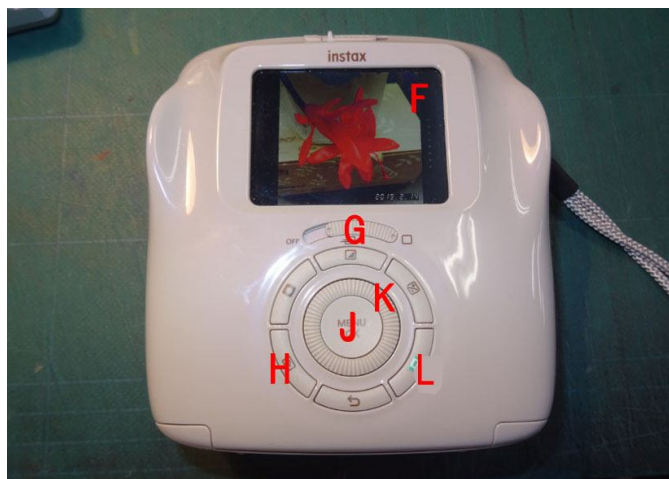
F ; モニター G ; スイッチ (OFF・動画・静止画) H ; 再生ボタン J ; 決定ボタン L : プリント K ; 画像選択・再生時ズーム環
