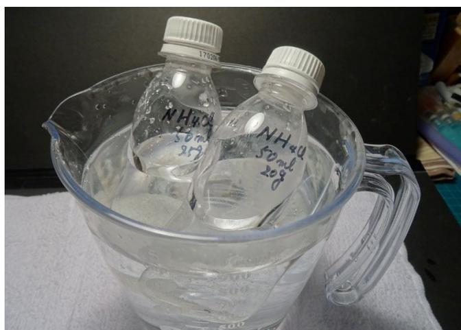
吸熱反応が起きるのは、溶解時のみなので、実験そのものには影響はない。2つの容器を 70°C のお湯で「湯煎」してみた。計算上は液温を 50°C より上げれば、25g のほうも完全に溶け切るはずだ。
