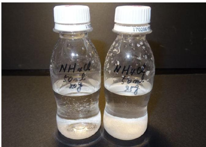
塩化アンモニウムを水に溶かすと、液温が急激に低下する。化合物は溶解する時に、発熱するものと吸熱するものがある。水酸化ナトリウムはたくさん溶解させると、液温が上昇してお湯のように温かくなる。塩化アンモニウムの場合は「吸熱的溶解熱」である。食塩の溶解でもこれは起きるが、あまり顕著ではない。容器は冷たくなり、液温を測ると 10°C 以上低下していた。計算上は常温の水 50mL に塩化アンモニウム 20g は、溶け切るはずなのだが、液温が 7°C まで下がってしまったので、底のほうに溶け残ってしまった。
