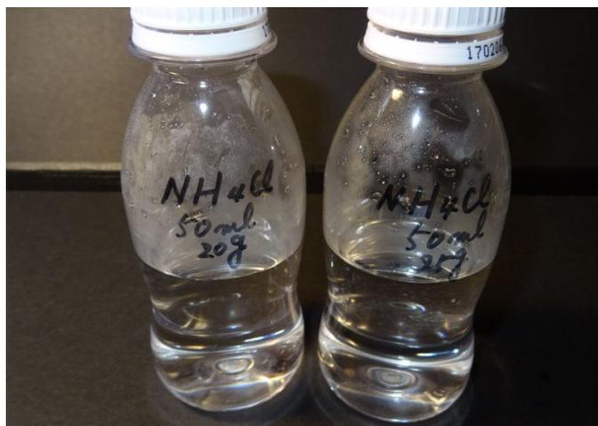
数分後、どちらの容器にも結晶はなくなった。このあと液温を下げれば、再結晶が見られるはずである。自然に冷却しても良いが、空気冷却だと時間がかかるので、水で冷やすことにした。
