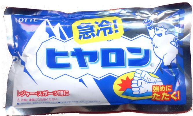
この「吸熱的溶解熱」を利用したものに、「瞬間冷却材」がある。スポーツ後や怪我の時に役立つ。写真の商品の場合、中に「硝酸アンモニウム+尿素」と「水」が分離されて入っている。外袋を強くたたくと、水袋が破れて物質が水に溶け、冷えるという仕組みだ。
