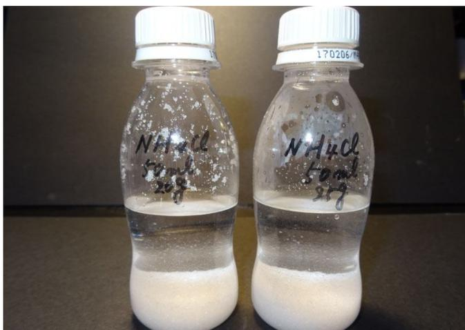
予備実験では、容器に 50mL の水 (約 17°C) を入れ、20g、25g の塩化アンモニウムの結晶を入れて攪拌して (振って) みた。
