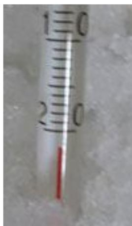
寒剤そのものにも、ちょっとした工夫が必要だ。砕いた氷と食塩の量は、2:1から3:1程度が良い。そうすると、融けだした水分で一気に飽和状態になり、寒剤の温度は-20℃以下になる。ビーカーの外側には、室内の水蒸気が昇華して、霜がつく様子が観察できる
