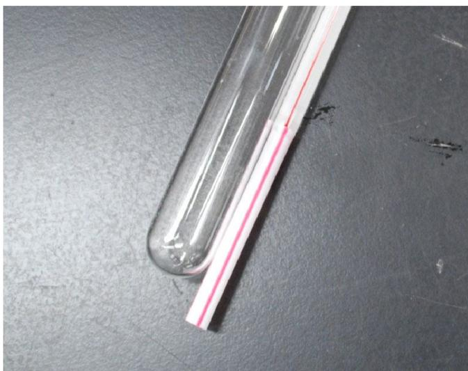
試験管に温度計を挿す前に、棒温度計の液だめ付近に、太めのストローを挿しておく和良好的。こうすると、液だめが試験管の底ではなく、少し浮いたところに位置するようになる。液だめ部分が試験管の底にあると、すぐに凍ってしまい、「凍りつつある水」の温度変化
