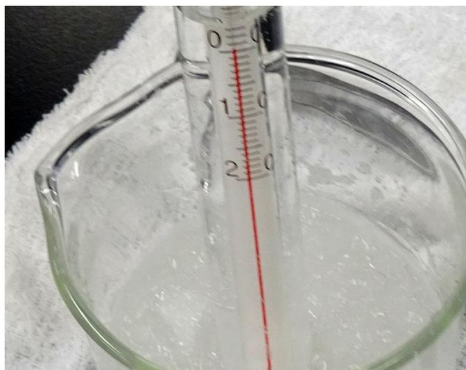
しかしこれでは、試験管の中の水も一気に温度が下がり、「0℃を通過」してしまう。「完璧な寒剤」だと、試験管内の水温は、1分間に10℃以上下がってしまうのだ。水もたちまち凍ってしまい、「ノートに記録している間に凍ってた」となってしまう。
