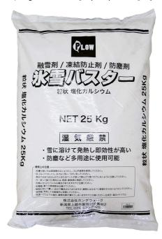
寒冷地の道路には、冬期に「融雪剤」が使用される。 北軽井沢の国道や県道では、大型の散布車が毎日大規 模に散布している。日本では「塩化カルシウム」(略 して「塩カル」)が使われることが多い。塩化カルシ ウムは非常に水に溶けやすく、飽和状態では−50℃ま で凍らないので、効果が大きい。海外では、より安価 な塩化ナトリウム(岩塩)が広く使われている。いず れも、自動車の下回りや、道周辺の構造物に、錆びな どの影響が大きいのが問題だ。
