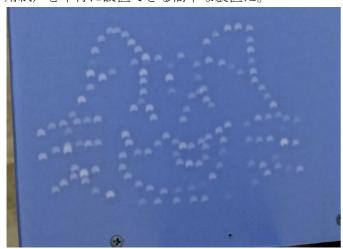
事前の実験で、ピンホールの大きさは、切手の目打ちの大きさ(直径約0.7mm)が最適とわかっていたが、この大きさの穴で絵や字を描くのはかなり難しい。しかし、穴は必ずしも円型である必要はない。この猫(ニャーゴ)の絵は、錐(四角い穴型)で作ったが、実際は日食の太陽の形に投影されていた。
