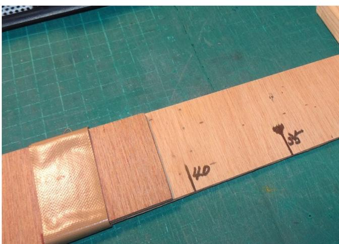
ベニア板は2枚が重なっていて、腰のベルトの調整のように、その長さを調整できるようにした。長さのおよその目盛りも打っておいた。何度か試した結果、切手目打ち穴(直径0.7mm)の場合、投影板との間隔が35cmの時、一番良い像を結ぶことがわかった。
