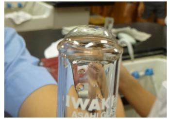
「手のひらで試験管を温めると、確かに中の空気の温度が上がる」---この事実を確かめられたので、やっと「温めると膨らむか」を調べることができる。試験管内を一旦水で満たし、その水を捨てて中の空気を一新する。その口にせっけん膜をつけて、再度試験管を温めると空気は膨張、せっけん膜は押し出される。
