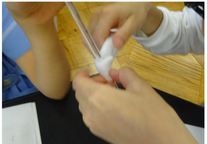
まず、温める前の空気の温度を測定する。試験管の中ほど(40℃付近)に、脱脂綿を巻く。試験管内部の空気が、できるだけ逃げないようにする工夫だ。
