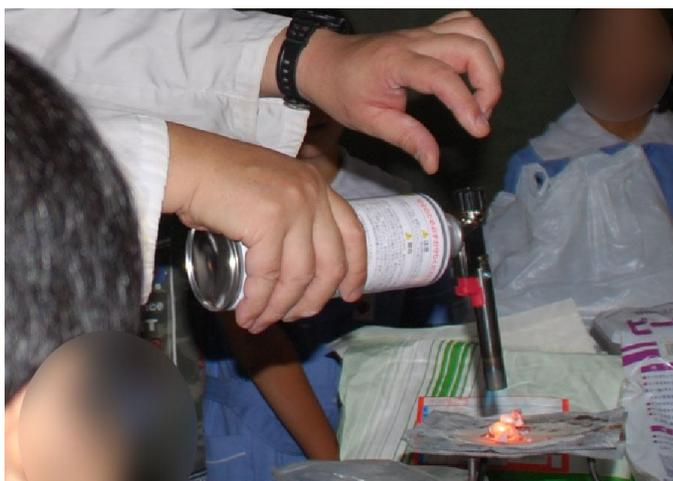
通常、こうした手持ち式のバーナーは、炭起こしや料理用で、中身はカセットコンロ用のボンベと同じで「ブタンガス」が充填されている。それでも 1000℃程度なら出せる。しかしこのボンベはブタンガスにプロパンガスが混入されていて、最高 1200℃ぐらいまで出せる。自動着火装置付きで、火力調節も可能だ。
