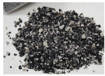
これが、芙蓉パーライトさんが送って下さった、パーライトの原料の黒曜石砕片である。1つの粒の直径は小さいもので5mm、大きなものでもせいぜい15mm程度だ。熱を加えて加工する原料なので、このように小さな粒のほうが速く熱が回って好都合なのだろう。
