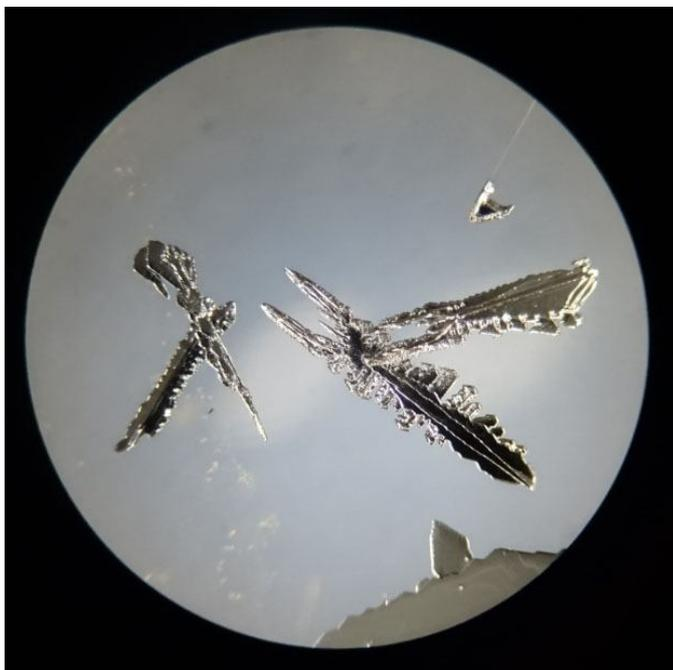
倍率は 40 倍 (対物 4 倍、接眼 10 倍) である。結晶は不透明なので、透過光 (反射鏡や LED 光源) は無効で、反射光 (天井光や自然光) で観察する。
