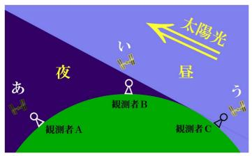
地上から ISS を見るには、図のように、観測者のいる場所は「夜」、ISS の飛んでいる高高度は太陽光が残っている状態の時だけである。これは、日の出直前か日没直後ということになる。図は高さを強調している。実際の ISS の高度は 400km 強なので、地球直径のわずか 3%の位置を飛行している。
