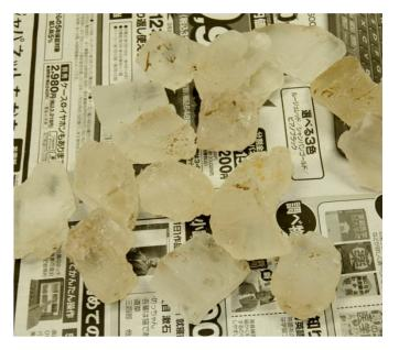
写真は「岩塩」である。天然の塩化ナトリウムの結晶(鉱物)である。比較的容易に入手でき、方解石と同じように「3方向の完全なへき開」がある。再結晶で出現する結晶の形と、衝撃によって割れたあとに現れるへき開面の形が、ほぼ一致しているのが面白い。
