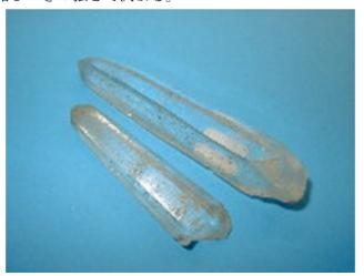
写真は、山梨県昇仙峡産の、非常に希少な水晶の結晶である(田中標本)。水晶は、断面が六角形の美しい結晶をしているが、分子の結合が強く、どんなに慎重に割っても、ガラスのように粉々に砕けてしまう。このような鉱物の場合「へき開なし」という。
