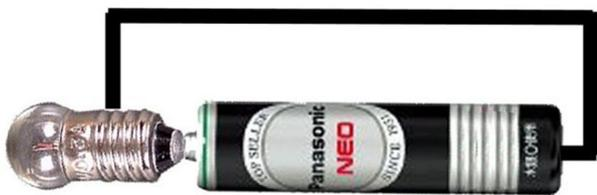
点灯させたいのは極性がない豆電球なので、乾電池の+極-極は逆なっても影響はない。また豆電球も、横にしても縦にしても良い。(実は横にしたほうが回路を成立させやすい。) この方法で導線を使うと、頻繁にショートが起きる。しかし、はさみではいかなるつなぎかたをしても、ショートすることはないので、電気的には安全な方法と言える。
