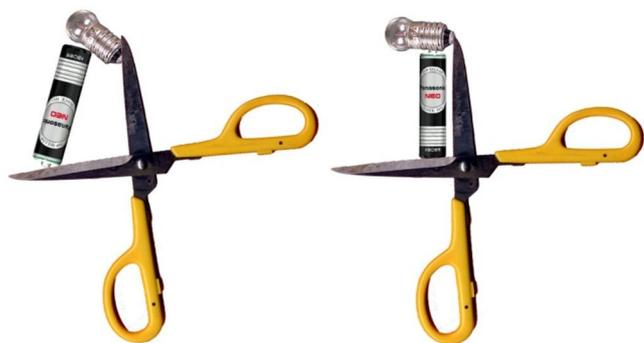
方法は上写真のように2通りある。実際に試すとわかるが、右側の方法のほうが、成功しやすい。いずれも3年生の子どもにとっては難しく、最初の20分間は、クラスの一人も成功しない。柔軟性に乏しいはさみでは、乾電池の極(特に-極)に接触させるのが難しいからだ。しかし30人以上も子どもがいれば、必ず成功者が現われる。
