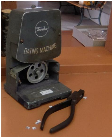
このマシンを左から右に切符を通すと、瞬時に切符の端に日付が刻印されるようになっている。動力は切符を通す力だけなので、どうしても硬い切符が必要なのだ。写真のマシン
