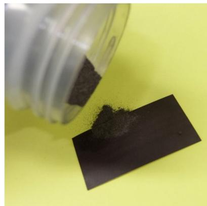
最初は、有効期限の切れた回数券で試してみた。写真のように切符の磁気面に鉄粉をふりかけ、ものさしで均一にならして見た。さて、結果はどうだろうか？
