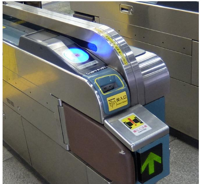
自動改札が登場したばかりの頃は、裏が黒い「磁気切符」専用だった。裏表×4方向のどの向きに入れても、瞬時に出口から出てくるところが素晴らしい。しかし最近では、IC乗車券や定期券(パスモやスイカ)が主流になって、地下鉄やE電(※)では、この磁気切符すら、あまり見かけなくなってしまった。
