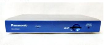
パナソニック製のこのサーバー(通称「弁当箱」) は、アナログのビデオ信号(音声も入力可能)を、動 画と静止画に変換し、インターネット経由で閲覧・転 送を可能にするものである。システムは相当に複雑で、 設置にはネットワークに関する、かなり詳しい知識が 必須である。(特にグローバルアドレスへの変換)
