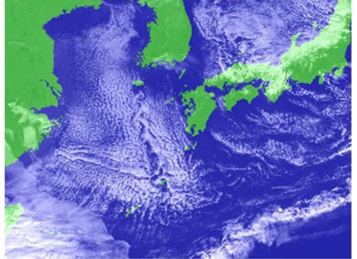
上の衛星写真は、済州島(チェジュ島=朝鮮半島南端)の風下側に発生した、カルマン渦列の例である。大気は透明なので、通常カルマン渦は見えない。しかし、一様な低い雲があると、気流によって雲の形が渦になり、カルマン渦が視覚化されたのである。
