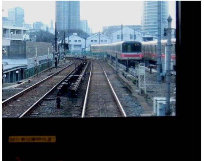
⑦やがて、茗荷谷の車両基地(検車区)の脇を通る。この検車区は、茗荷谷の底に築堤を造って平らにし、線路を何本も敷いたものだ。従って、車両基地の線路端は、相当な高さの築堤になる。そのことは、色別標高図で見てもよくわかる。
