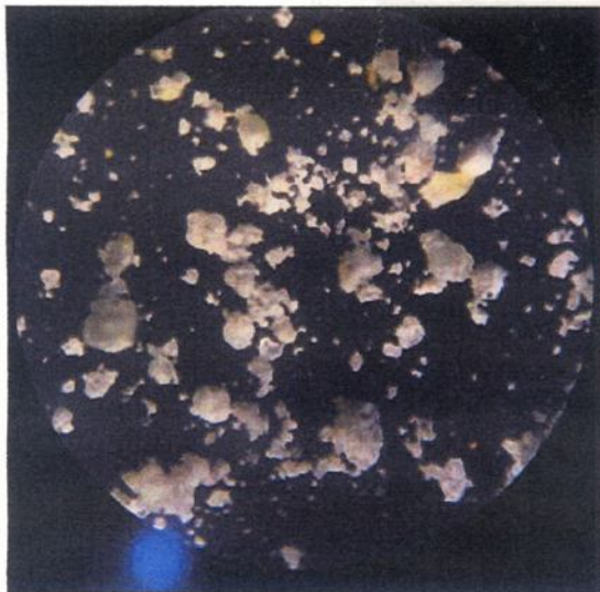
左) 顕微鏡写真 (×100) 石英・輝石 などが見える 撮影; C.Tanaka 下左) 火山灰の写真 右下) 葉についた火山灰 これで約0.1g/m 2
