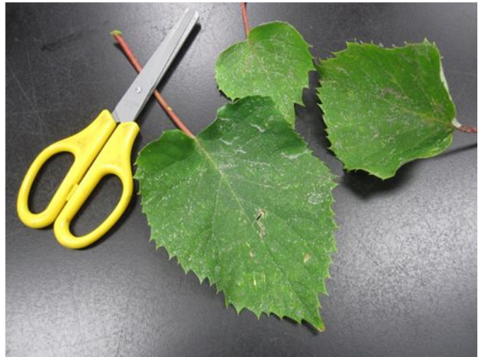
「火山灰の付着した葉」 箱根町強羅早雲山 火山灰自体も貴重であるが、この葉も重要な物件。火山灰の密度から、 m^2 あたりの降灰量が推定できる。火口から採取地点の距離がはっきりしているため、噴火による火山灰総排出量も計算できる。
