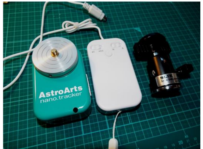
「ナノトラッカー」 アストロ・アーツ社製 左から、本体(赤道儀)、コントローラ(電池内蔵)、自由雲台。価格もセットで市価2万円程度。
