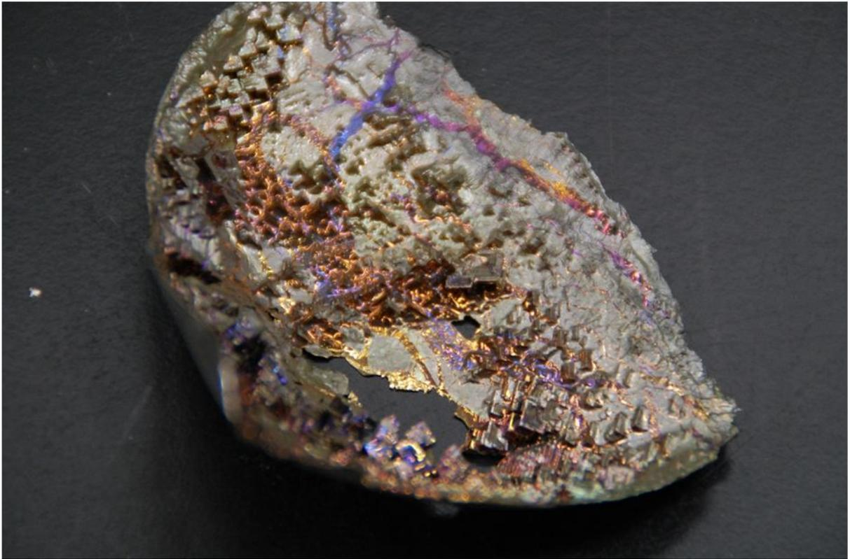
下の写真が、再結晶したほうのビスマスを、容器から取り出したところです。ビスマスは、液体から固体になる時に体積が大きくなるのですが、意外に簡単に取り出せました。非常にもろく、注意して扱わないと、崩れてしまいます。
