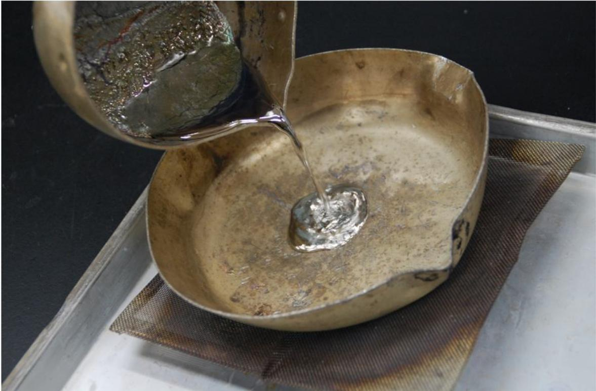
完全に融け終わったら、少しさめます。その時、融解ビスマスの中に、固体ビスマスが再結晶するはずなのです。食塩やミョウバンの再結晶とちがうところは、「溶媒」がないことです。結晶も液体も同じ物質（ビスマス）です。しかも金属は不透明なので、中の再結晶の様子がわかりません。本来はここで、トンゲや「るつぼばさみ」のようなもので、結晶をつかみ出します。しかし、今回は融かした量が少なかったなので、逆にまだ液体の部分を流し出してみました。放熱の為に、下にアルミのお盆と、ステンレス網を置いてあります。あ！すでに底に結晶が見えていますね。
