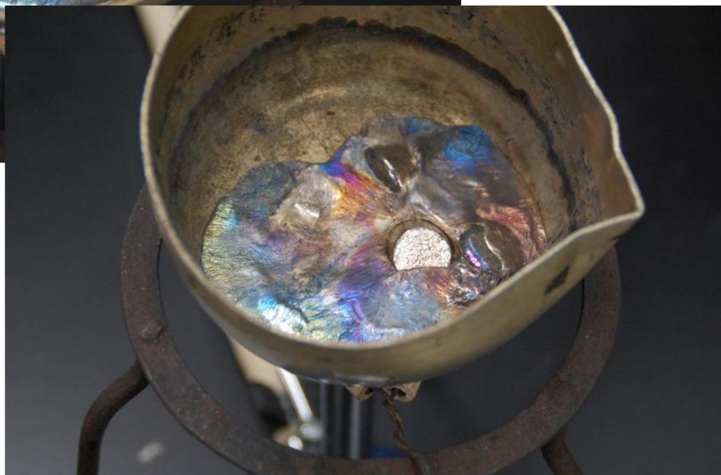
上の写真が融け始めたところです。三脚に三角架をかけて、その上にアルミニウム容器を直接載せています。ガスバーナーの火力は、やや強めにしています。錫の融解と同じで、水分は禁忌なので、その点は十分注意しました。ほんの 2~3 分で融け始めます。一旦液体の部分ができる、そこに飲み込まれるように次々と融解してゆきます。数分後には、ほぼ液体になりました。表面の酸化被膜には、すでに美しい色がついています。
