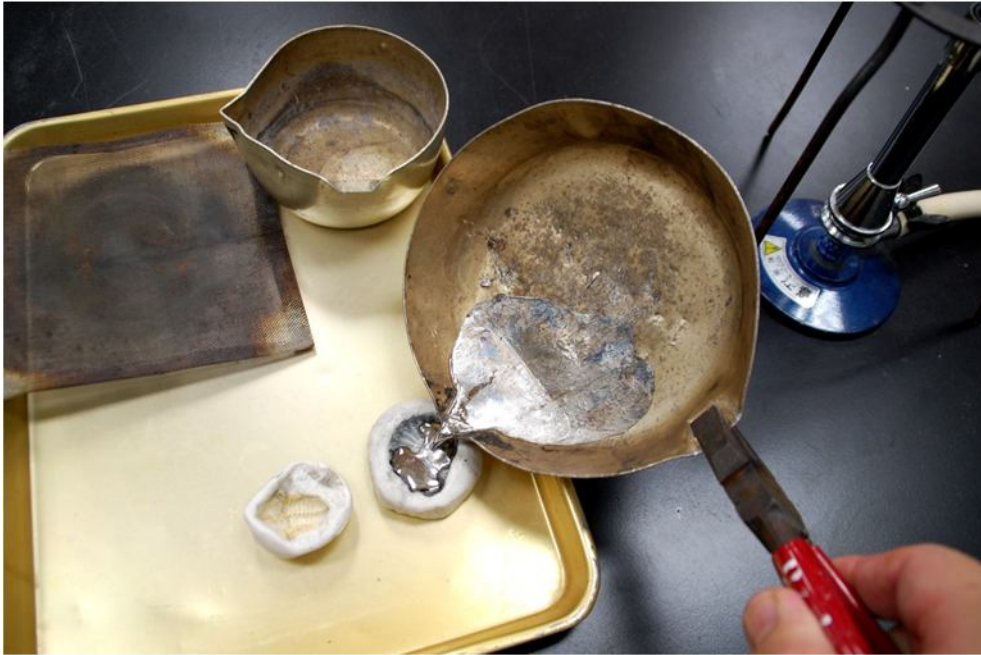
「融かした金属ビスマスを型に流し込む」
